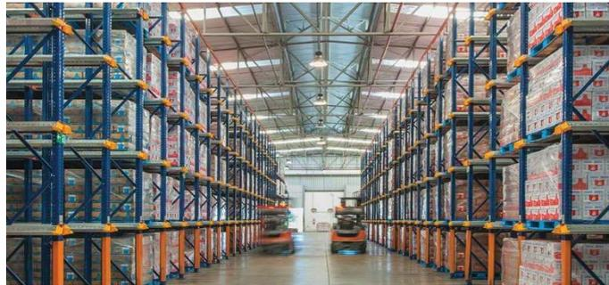
Gambar 2.4 Contoh Susunan *Drive-In Rack* pada Gudang
