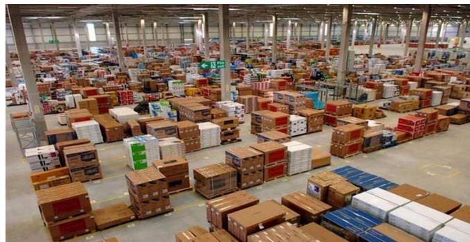
Gambar 2.1 Contoh Susunan *Blocking Stacking* pada Gudang
