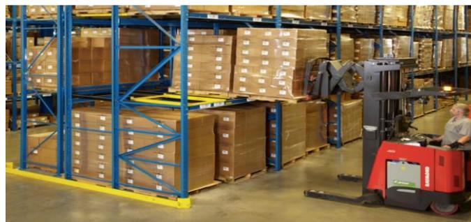
Gambar 2.5 Contoh Susunan *Push-Back Rack* pada Gudang
