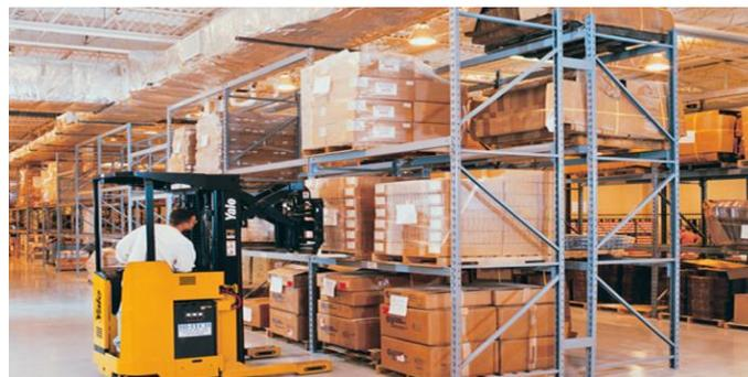
Gambar 2.3 Contoh Susunan *Pallet Rack* pada Gudang
