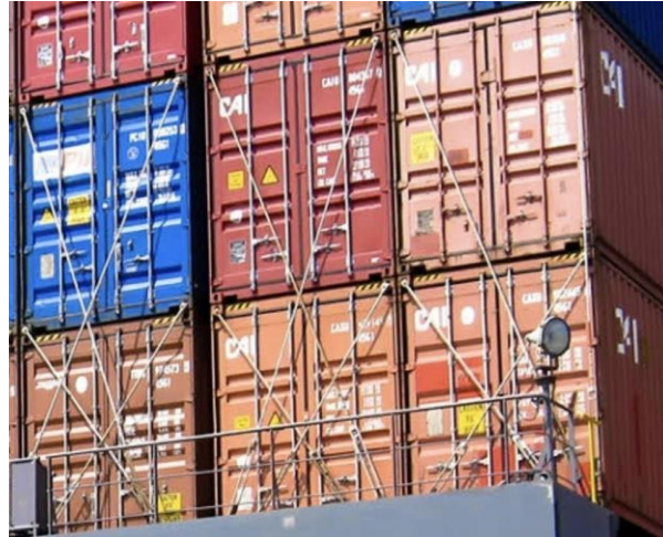
Gambar 2.4 Lashing crossing lashing pada peti kemas.
