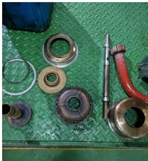
Gambar 4. 27 Pembersihan Komponen Purifier Sumber : Dokumen Penelitian (2023)
