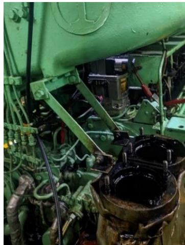
Gambar 4. 21 Membersihkan Filter Bahan Bakar Saat Mesin Mati Sumber : Dokumen Penelitian (2023)
