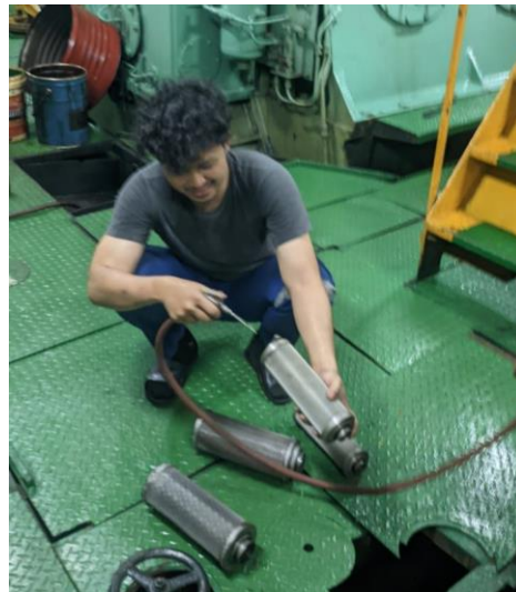
Gambar 4. 26 Pembersihan Filter Bahan Bakar Sumber : Dokumen Penelitian (2023)
