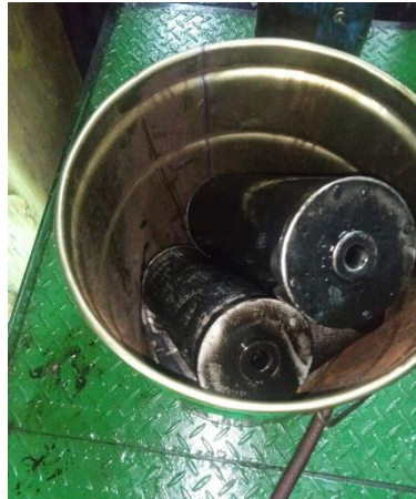
Gambar 4. 6 Filter Bahan Bakar Yang Kotor Sumber : Dokumen Penelitian (2023)
