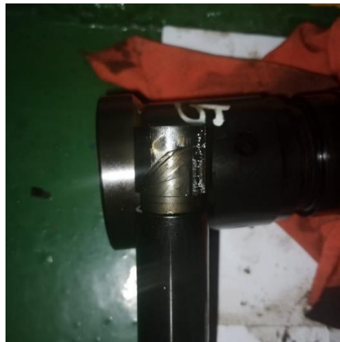
Gambar 4. 18 Komponen Fuel Injection Pump Yang Aus Sumber : Dokumen Penelitian (2023)
