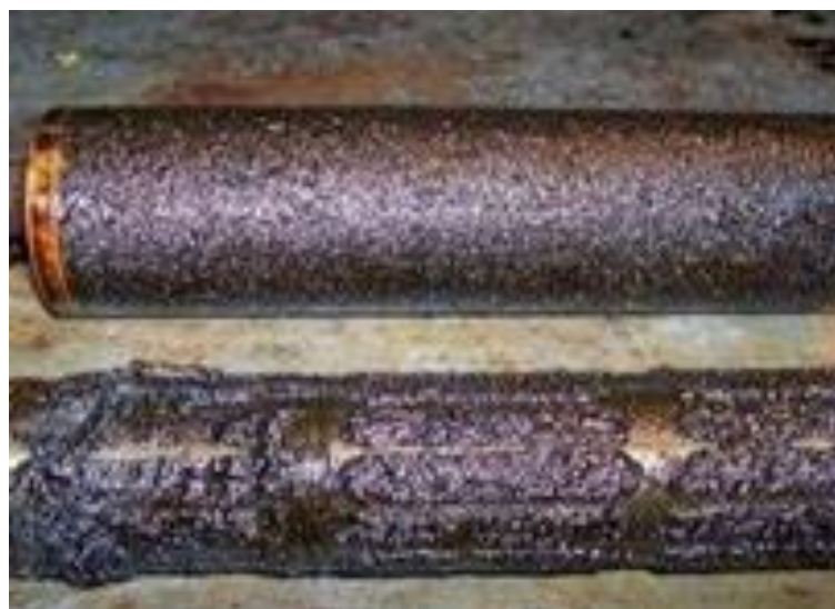
Gambar 4. 10 Filter Bahan Bakar Yang Kotor Sumber : Dokumen Penelitian (2023)
