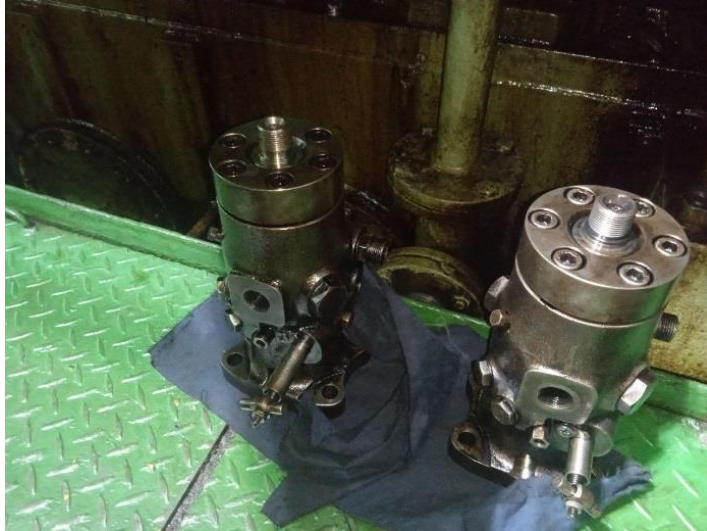
Gambar 4. 23 Fuel Injection Pump Yang Siap Dipasang Kembali Sumber : Dokumen Penelitian (2023)
