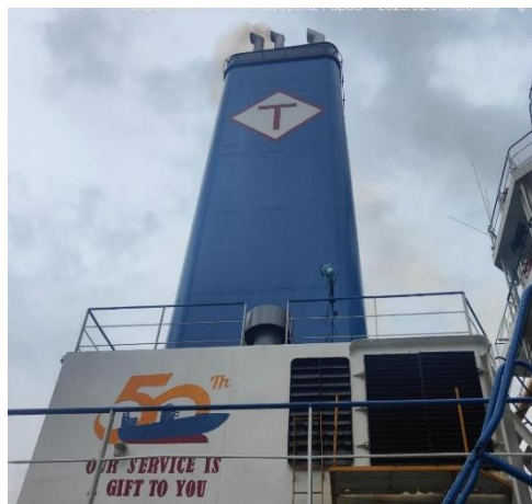
Gambar 4. 15 Asap Putih Pada Cerobong Sumber : Dokumen Penelitian (2023)
