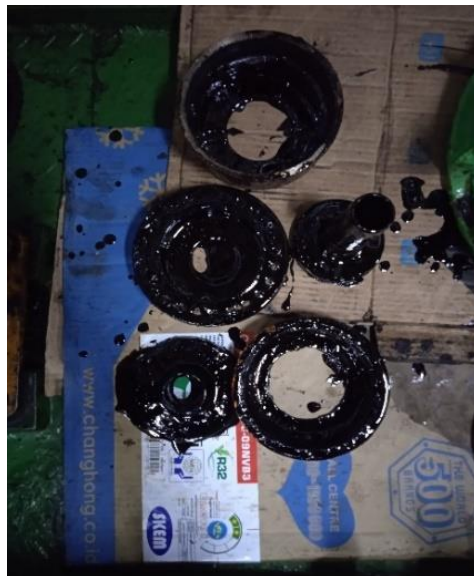
Gambar 4. 13 Bukti Purifier Kotor Sumber : Dokumen Penelitian (2023)
