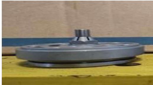
Gambar 2. 22 katup hight pressure dan low pressure (Sumber : Dokumen pribadi)
