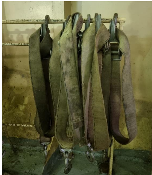
Gambar 4.3 Lashingan rusak Sumber : Data Observasi, 2023
