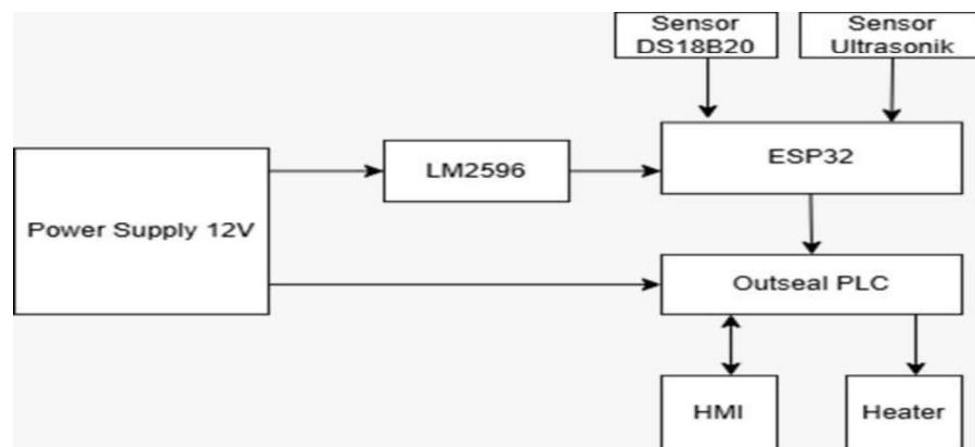
Gambar 3. 2 Blok Diagram
