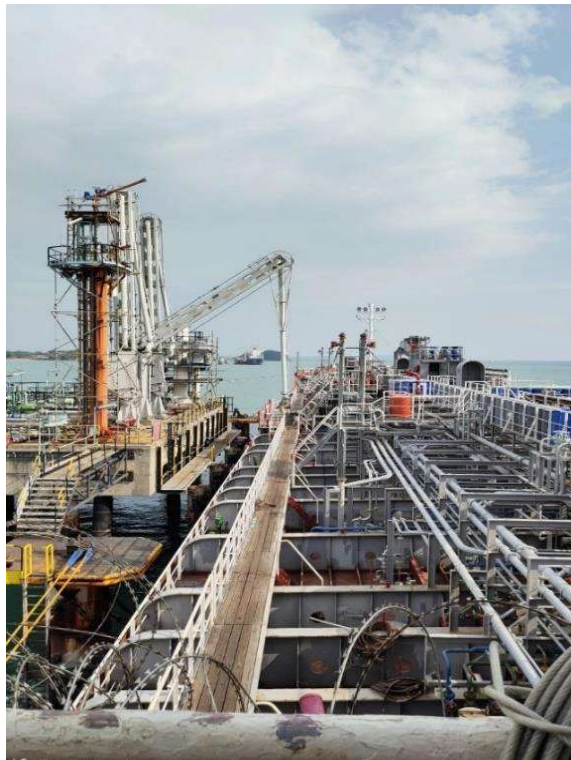
Gambar 2.6 Proses Discharge kapal MT. Harsanadi Sumber: Dokumentasi Penulis
