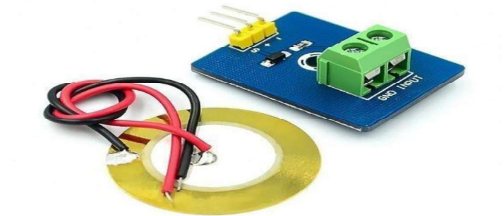
Gambar 2. 6 Desain Sensor Piezo
