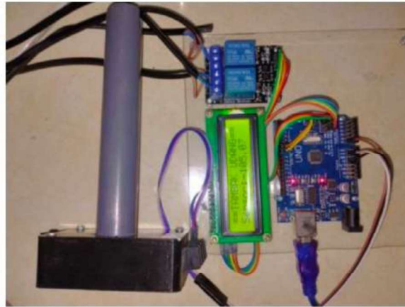
Gambar 2. 4 Rangkaian Sensor Konduktivitas Salinometer
