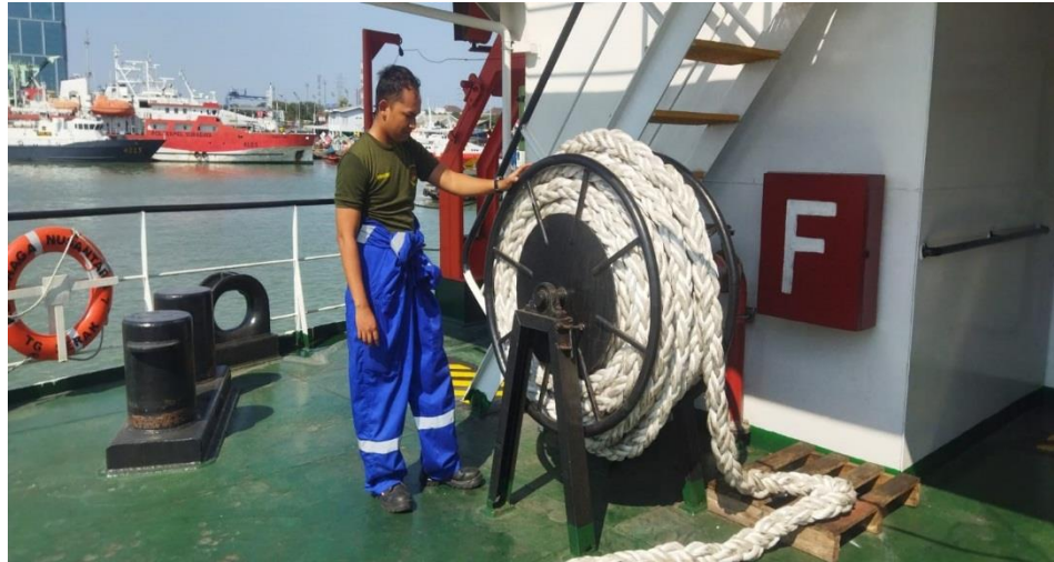
Gambar 2. 3 ABK Mengecek Kondisi Tali Tambat
