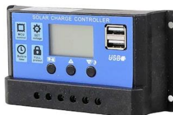
Gambar 2.7 Solar Charge Controller Sumber: Foto Pribadi Penulis (2023)
