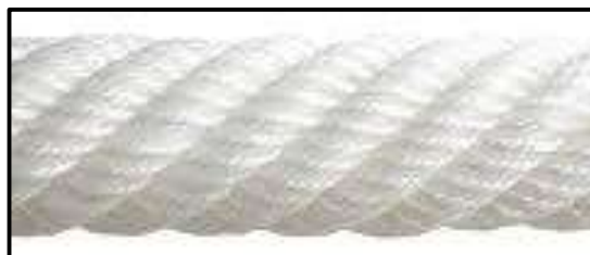
Gambar 2. 8 Serat Poliamida mono dan Multifilamen
