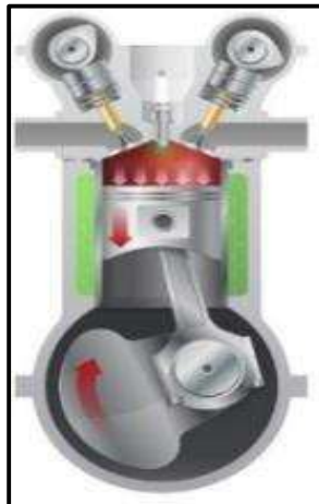
Gambar 2.27 Pembakaran dan pendorongan (power)
