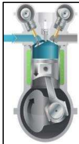
Gambar 2.25 Langkah hisap ( intake )
