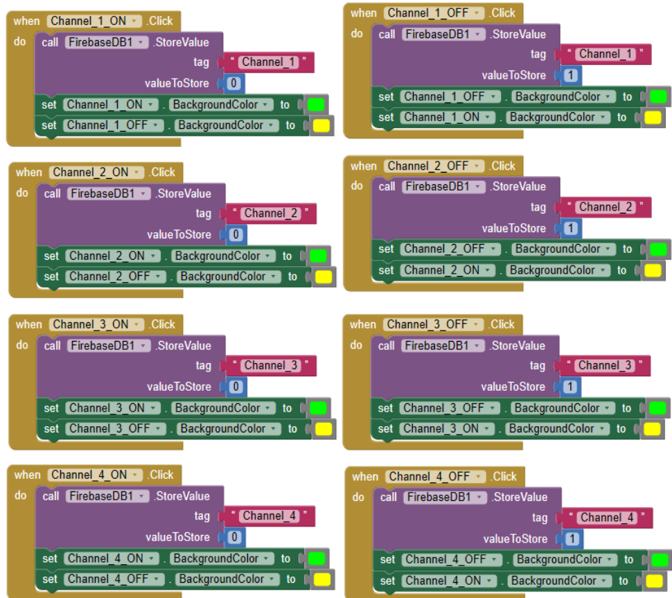
Gambar 3. 5 Skema blok kerja aplikasi pada sistem Sumber : Dokumentasi Pribadi
