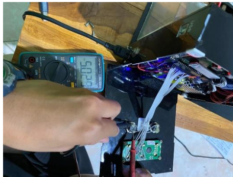
Gambar 3. 31 Tegangan 5V DC pada push button start . (Sumber: Dokumen pribadi)
