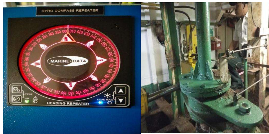
Gambar 3.6 Compass Repeater (kiridan Poros Kemudi (kanan). Sumber. Dokumen Pribadi (2024)
