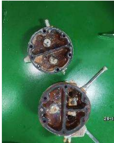
Gambar 2.7 Buka cover kondensor untuk dilakukan pembersihan Sumber : Dokumen Pribadi
