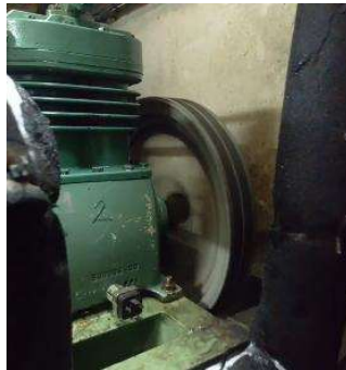
Gambar 2.5 Pergantian Vanbelt pada kompressor
