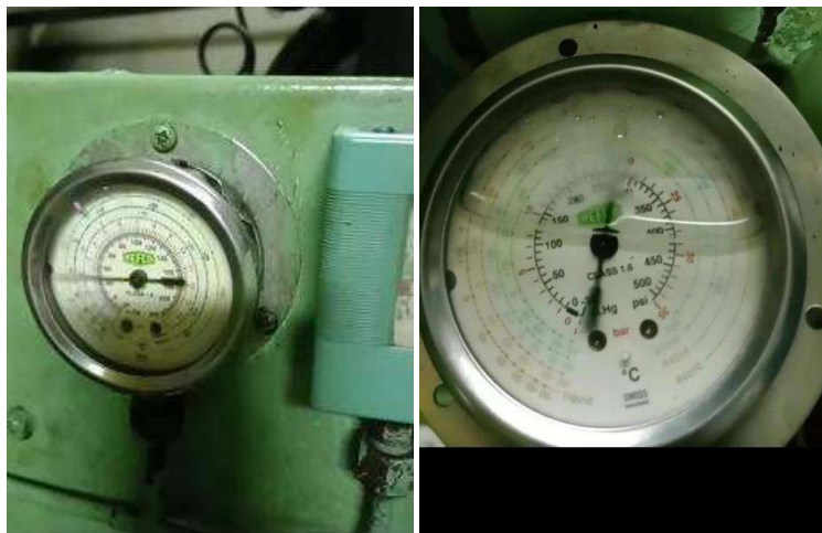
Gambar 2.8 Memperhatikan tekanan kompresor secara berkala Sumber : Dokumen Pribadi
