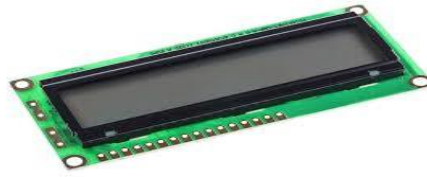
Gambar 2.6. LCD ( Liquid Crystal Display ) Sumber: Dokumen Pribadi (2023)
