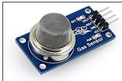
Gambar 2. 8 Sensor MQ-4 Sumber : Imam Syukhron (2021)
