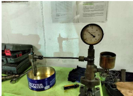
Gambar 2. 1 Proses Pengetesan Injector Sumber : Dokumentasi peneliti
