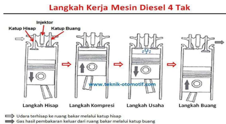
Gambar 2. 16 Prinsip Kerja Mesin
