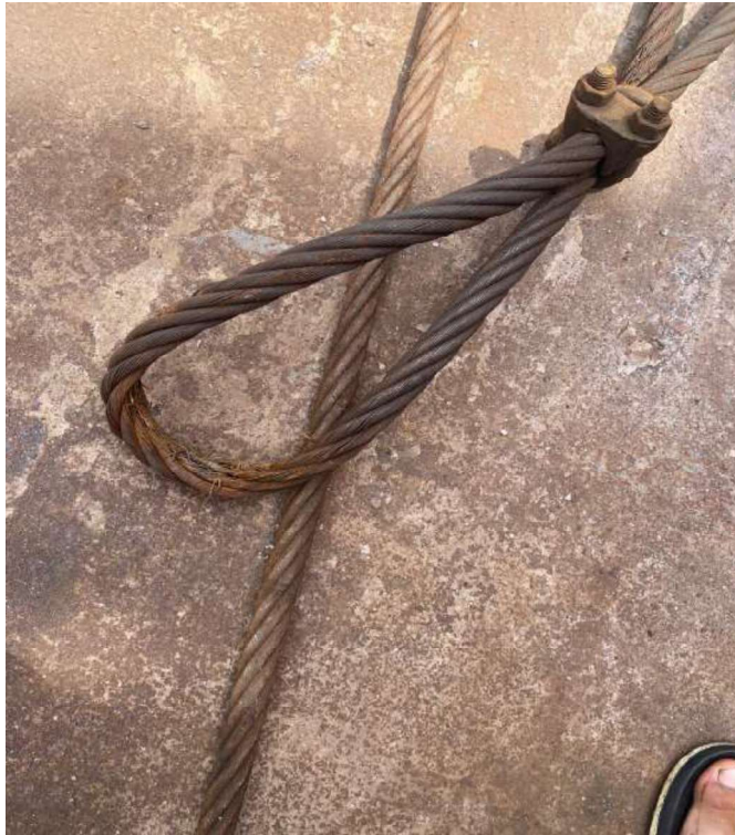
Gambar 1.2 Kondisi Wire Rope yang mengalami kerusakan fisik Sumber : Dokumentasi Pribadi (2024)
