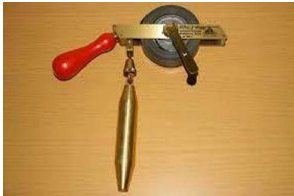
Gambar 2.15. Soundingan yang di gunakan untuk mengukur innage pada tangki muatan minyak.
