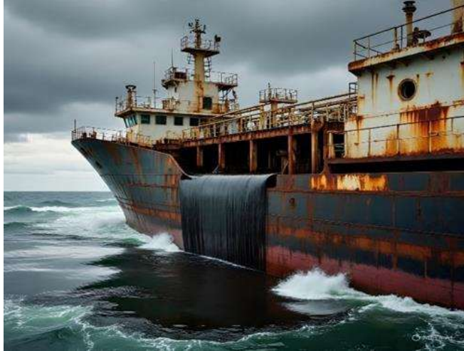
Gambar 2.8. Kebocoran tangki pada kapal akibat muatan tidak sesuai kriteria
