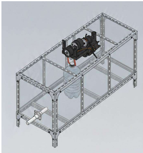
Gambar 3. 4 Rancang Bangun Pembangkit Listrik Tenaga Gelombang Laut Menggunakan Recoil Starter (Sumber: Dokumentasi Peneliti)
