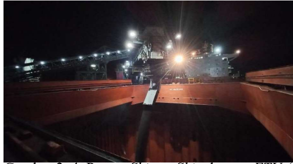
Gambar 2. 4. Proses Ship to Ship dengan FTU (conveyor) Sumber : Dokumentasi Pribadi
