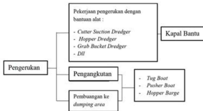
Gambar 2.9. Komponen Proses Pengerukan Sumber: DITJENHUBLA (2017)
