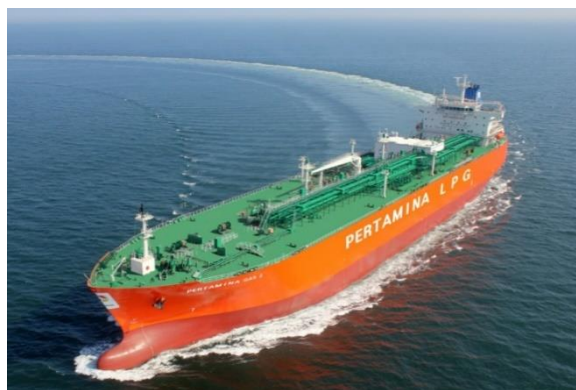
Gambar 2. 3 Kapal Pertamina Gas 1 tipe Fully-refrigerated Sumber: ruangenergi.com
