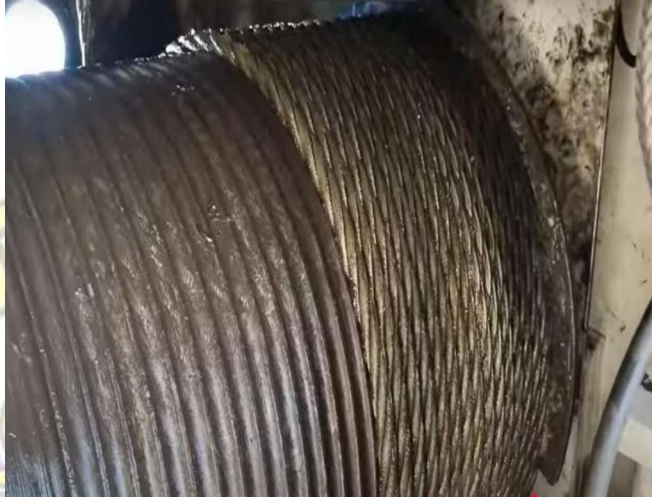
Gambar 2. 4 Wire Baru yang sudah terpasang
