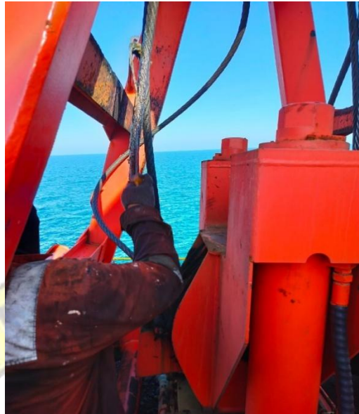
Gambar 4. 10 Cadet melakukan greasing wire grab Sumber : Dokumentasi Penulis
