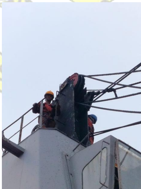
Gambar 4. 8 Crew deck melakukan penggantian wire luffing Sumber : Dokumentasi Penulis
