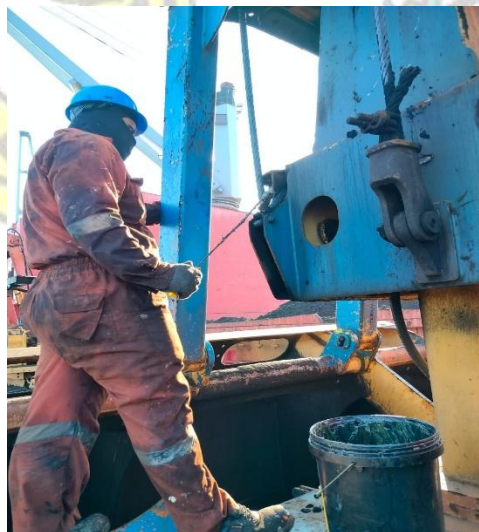
Gambar 4. 6 Juru Mudi melakukan Greasing Wire Grab Sumber : Dokumentasi Penulis
