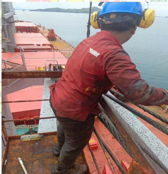
Gambar 4. 7 Bosun melakukan Greasing Wire Crane Sumber : Dokumentasi Penulis
