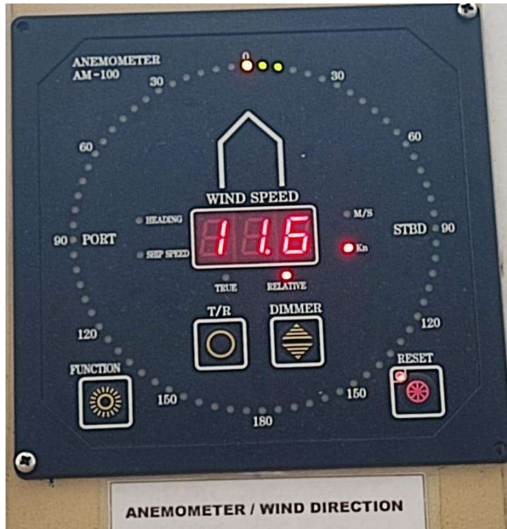
Gambar 2. 7 Anemometer Sumber : Data Peneliti (2023)
