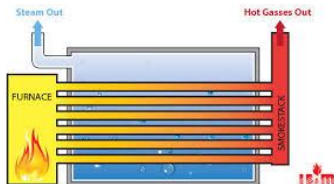
Gambar 2. 4 Mekanisme Fire Tube
