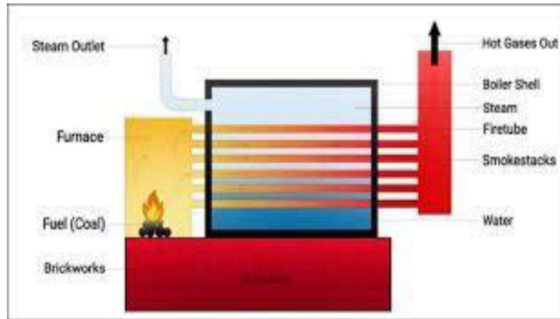
Gambar 2.1 Ketel pipa api Sumber: www.anakteknik.co.id
