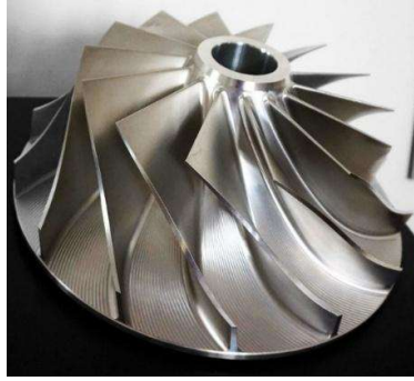
Gambar 2. 13 Bahan alluminium alloy pada impeller
