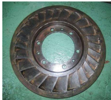
Gambar 2. 11 Nozzle ring Sumber: Dokumentasi penelitian
