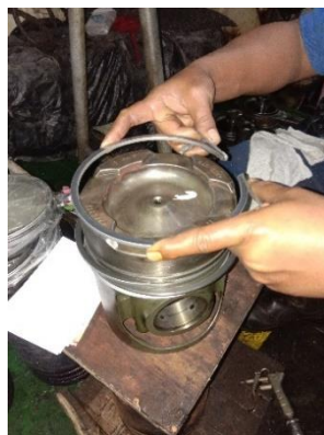
Gambar 4. 14 Pemasangan Sparepart Piston Ring yang baru Sumber : Dokumen Peneliti (2023)
