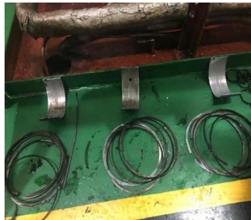
Gambar 4. 7 Ring Piston yang rusak Sumber : Dokumen Peneliti (2023)
