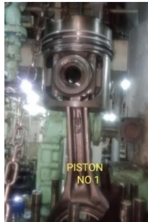
Gambar 4. 10 Pencabutan Piston No. 1 Sumber : Dokumen Peneliti (2023)
