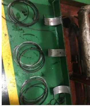
Gambar 4. 12 Piston Ring yang sudah rusak Sumber : Dokumen Peneliti (2023)
