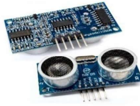
Gambar 2. 2 konsep sensor Ultrasonik
