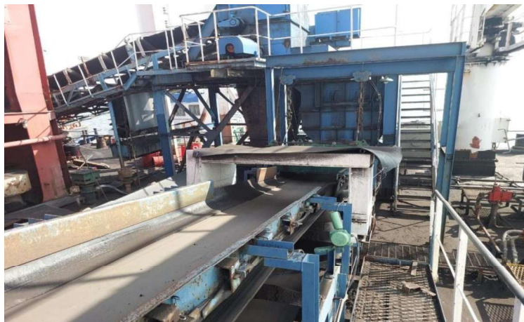
Gambar 2. 3 Conveyor dan Metal Detector di MV.WHS Iskandar 1 Sumber: koleksi pribadi
