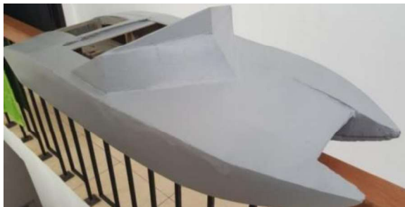
Gambar 3. 8 Tampilan Lambung Kapal Setelah di Cat
