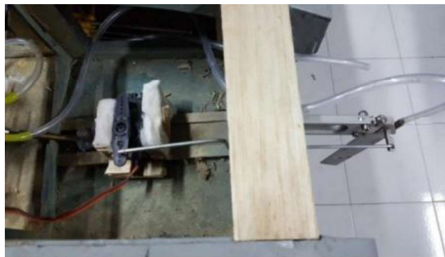
Gambar 3. 10 Perancangan Sistem Kemudi Kapal Sumber: Tugas akhir Unmanned Surface Vehicle untuk mencari lokasi tumpahan minyak menggunakan Ardupilot Mega (2025)
