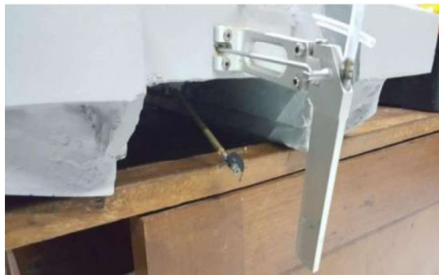
Gambar 3. 9 Penempatan Rudder dan Propeller Pada Kapal Survei Sumber: Tugas akhir Unmanned Surface Vehicle untuk mencari lokasi tumpahan minyak menggunakan Ardupilot Mega (2025)
