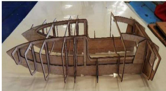
Gambar 3.7 Kerangka Lambung Kapal
