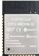
**Gambar 2.4** Bentuk fisik modul ESP32
