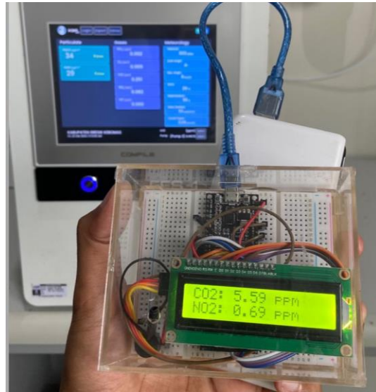
Gambar 4. 5 Pengujian Presisi Alat Pendeteksi Polusi Udara dengan Alat Ukur
