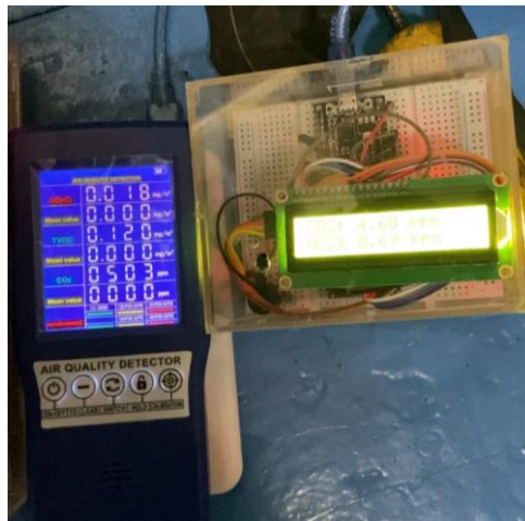
Gambar 4. 3 Pengujian Presisi Alat Pendeteksi Polusi Udara dengan Alat Ukur
