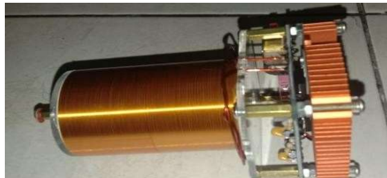
Gambar 4. 2 Gambar Rangkaian konstruksi tesla coil Sumber : Dokumen pribadi
