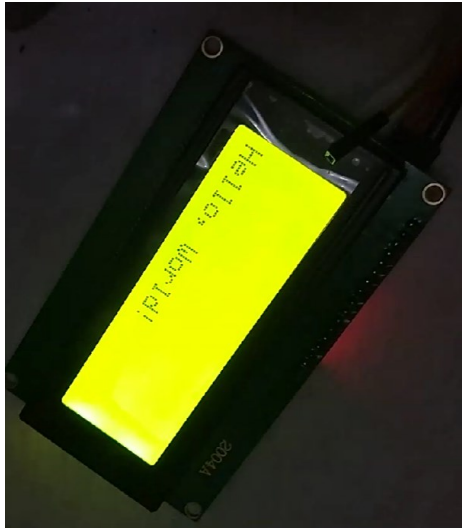
Gambar 4.1 Pengujian LCD I2C Sumber : Disusun Oleh Penulis
