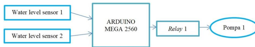
Gambar 3.1 Blok Diagram Sistem Pengisian Air Sumber: Dokumentasi Pribadi.
