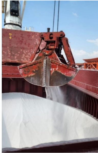
Gambar 2.1 Proses Pengambilan Cargo dengan Grab Sumber Dermaga Berlian Manyar Sejahtera
