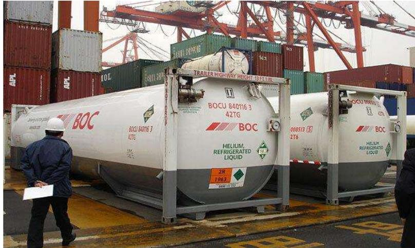
Gambar 2. 3 contoh muatan berbahaya kelas 2 *Gases compressed*
