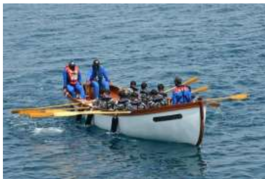
Gambar 2. 1 Lifeboat dengan penggerak dayung Sumber: https://shorturl.at/rxCK8
