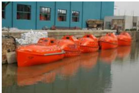
Gambar 2. 8 Sekoci dengan sistem udara otomatis ( Self Contained Air Support System )
