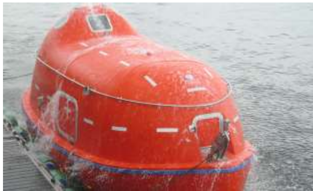
Gambar 2. 9 Sekoci dengan pelindung tahan api ( Fire Protected Lifeboat ) Sumber: https://rb.gy/3r4cb1
