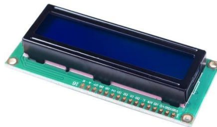
Gambar 2.5 Bentuk Fisik Liquid Crystal Display (LCD) 16 x 2 Sumber: 613Hg5qdRFL.AC.SL1500.jpg (1436x668) (geeksvalley.com)
