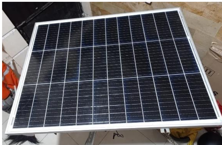
Gambar 2.1 Panel Surya 100wp Sumber : Dokumen Pribadi
