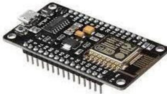
**Gambar 3. 3 NodeMCU**
