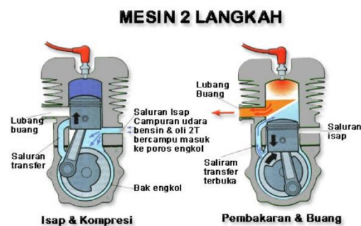
Gambar 2.3 Langkah-langkah mesin 2-tak
