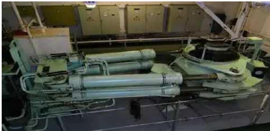
Gambar 2. 7 Bagian Utama Sistem Kemudi Kapal Sumber : Faldi, 20222
